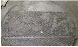
Rohrbündelwärmetauscher ohne Filter nach 4 Monaten
